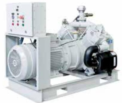
Conjunto motocompresor, accionado directamente por motor eléctrico, embridado al compresor. Equipado con cuadro de maniobra y, puede estar equipado con sistema de regulación para trabajar largos periodos a presión de trabajo constante. Es la mejor solución para una instalación fija con toma eléctrica en el punto de descarga.
