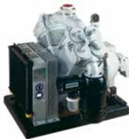
Conjunto motocompresor, accionado directamente por motor hidráulico, embridado al compresor, formando un robusto y compacto conjunto. Equipado de un refrigerador para enfriamiento del aceite del circuito hidráulico y con ventilador accionado por el cigüeñal del compresor.
